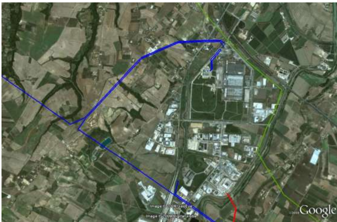
Figura 1. Linee elettriche ad alta tensione nell'area del polo industriale di Termoli. In blu linee elettriche a 150 kV, in rosso linea elettrica a 380 kV, in verde linee elettriche 150 kV delle Ferrovie dello Stato.
